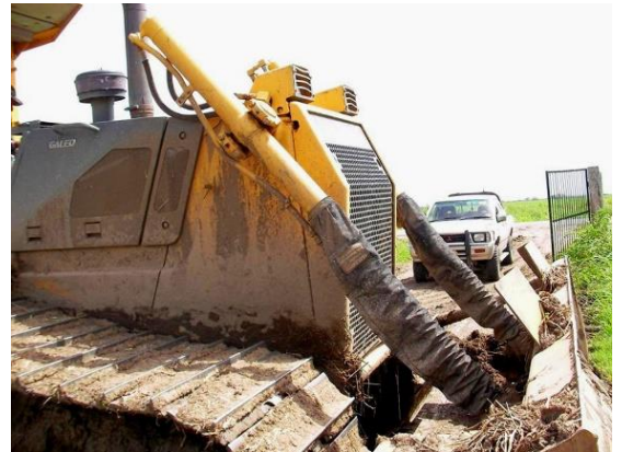
Protectores para cilindros de Bulldozer GALED
